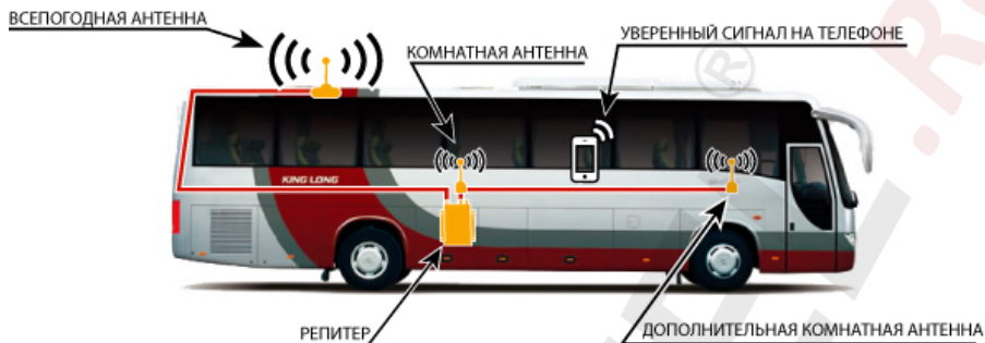
Схема №1. Пример установки репитера в автобусе.
